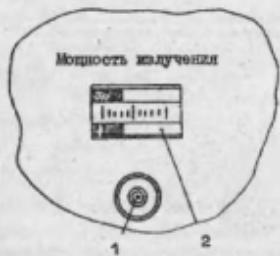
Рис.2. Индикатор мощности лазерного излучения: 1 - фотоприемное гнездо; 2 - стрелочный прибор
