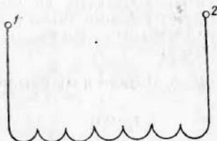
Рис. 6. Схема обмотки дросселя УГД-3
