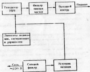
Рис. 2. Схема электрическая структурная аппарата УВЧ-30
